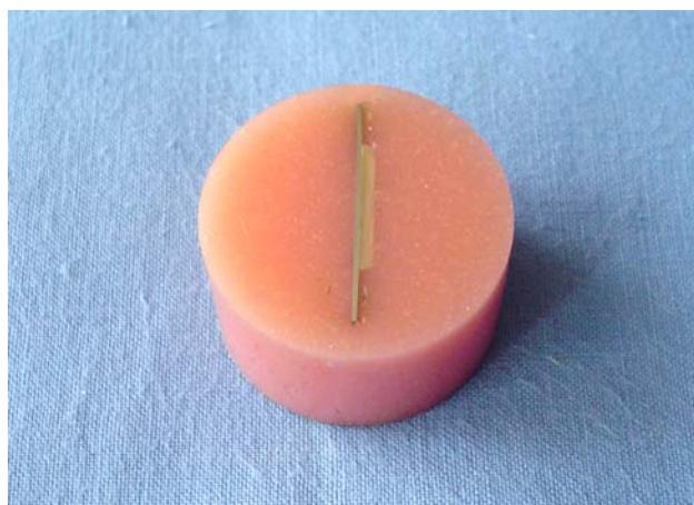
Sl. 1 – Metalografski ispoliran metal-keramički uzorak
