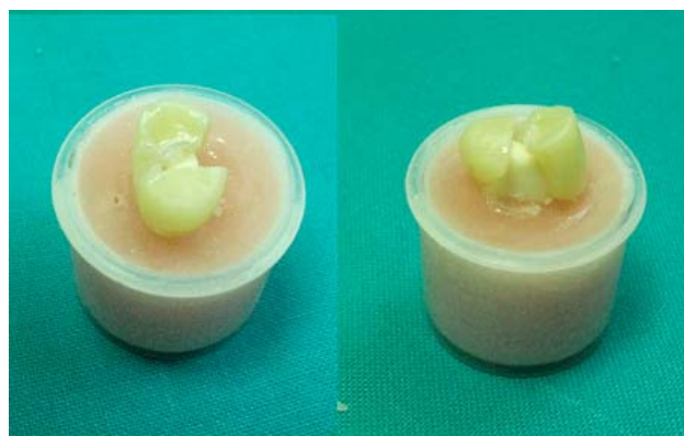
Sl. 8 – Lom keramičke kruna pod dejstvom opterećenja
