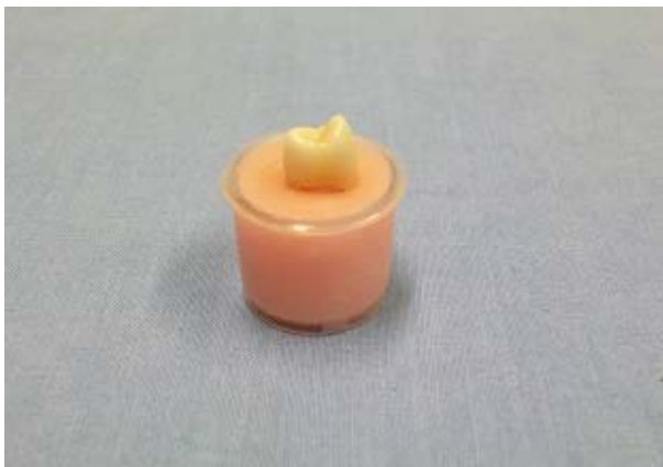
Sl. 2 – Premolar postavljen u autopolimerizujući akrilat
