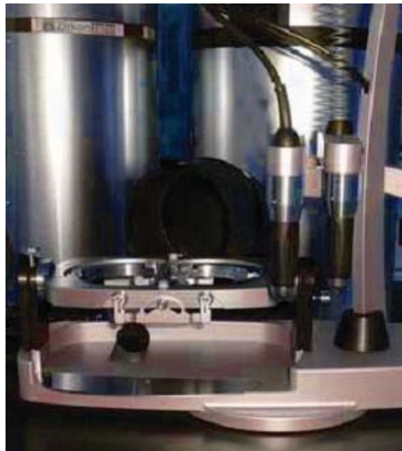
Sl. 4 – Uređaj za kopirajuće frezovanje keramičkih blokova, tipa “Zirkograph” (ZirkonZahn, Germany)
