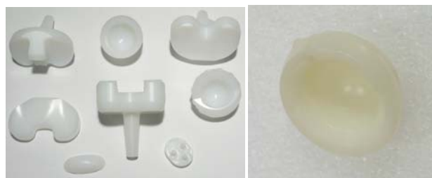
Sl. 7 – Delovi proteza od polietilena (UHMWPE)
