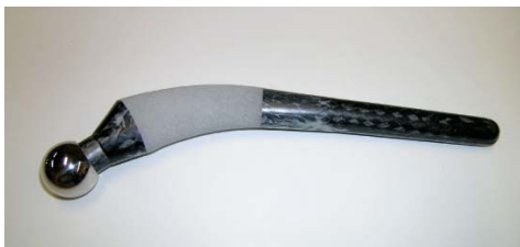
Sl. 8 – Veštački kuk od kompozitnog materijala
